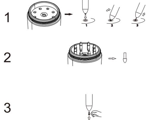
Abbildung 2-4: die Ersatzspitzen ersetzen
