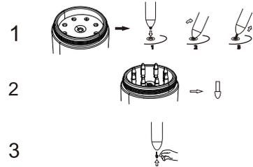
Abbildung 2-4: die Ersatzspitzen ersetzen
