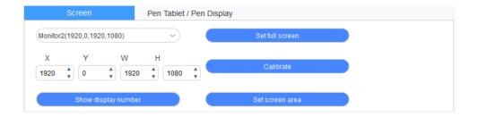
Wenn im Dupliziermodus mehrere Monitore verwendet werden (d. h. alle Monitore zeigen dasselbe Bild), wird der Arbeitsbereich des Geräts auf allen Monitoren abgebildet. Wenn sich der Stift im Arbeitsbereich bewegt, bewegt sich der Cursor auf allen Monitoren gleichzeitig.
