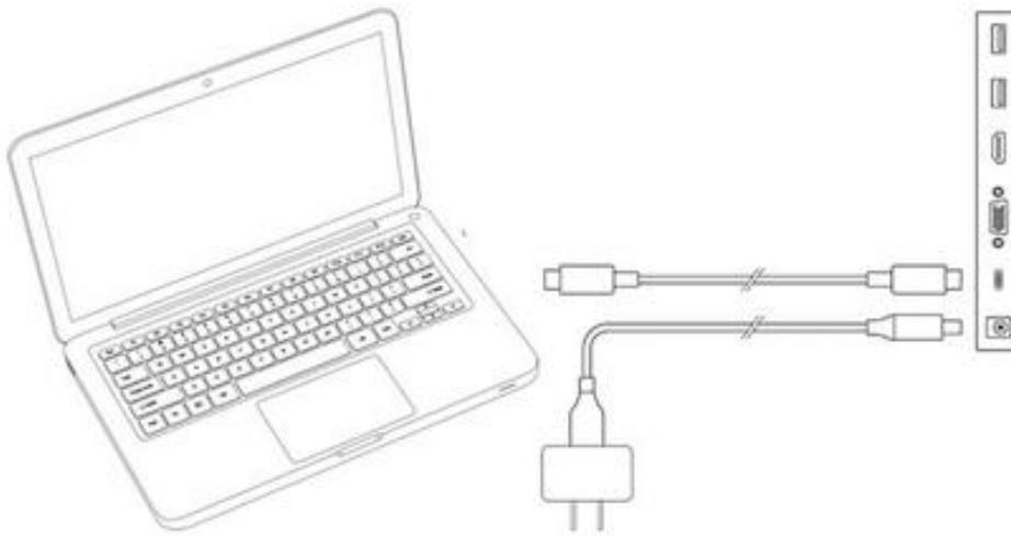
Bild 2-1. Typ-C-Verbindung
