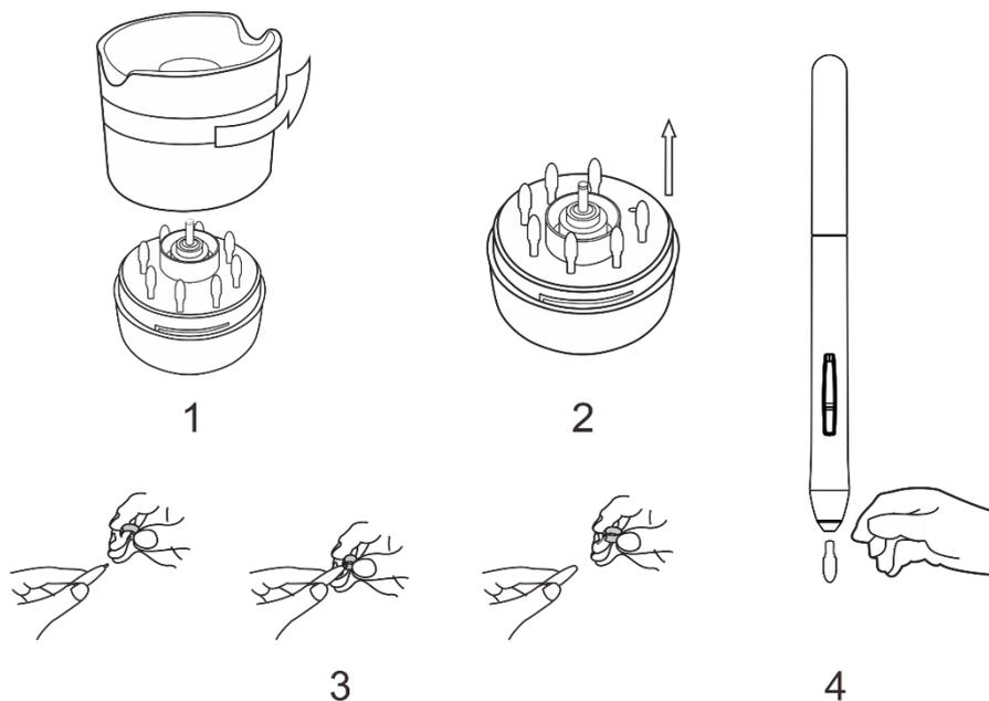
Abbildung 2-2: die Ersatzspitzen ersetzen
